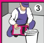
3. Для подготовки раствора залейте водопроводную воду комнатной температуры в чистую ёмкость из расчёта 0,23-0,26 л воды на 1 кг сухой смеси для фракций 1,0; 1,5; 2,0. На 1 мешок 25 кг – 5,75-6,5 л воды. Для фракции 2,5 взять 0,26-0,30 л воды на 1 кг сухой смеси (6,5-7,5 л воды на 1 мешок 25 кг).
