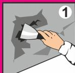
1. Подготовьте основание, удалите с него ослабляющие сцепление вещества: масляные и битумные пятна и прочие загрязнения. Отслаивающиеся участки удалите стальным шпателем. При оштукатуривании фасадов наружную гидроизоляцию и установку водоотводящих систем выполните до начала работ.
